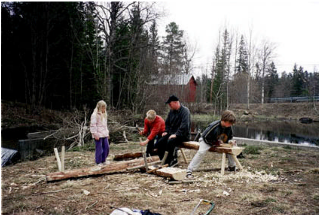
Stockar klövs med kil och slägga och sedan tillverkades bänkar att sitta på.
